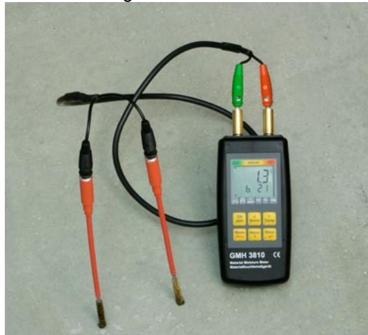
Betonmessung mit Bürstensonnen GBSL91
