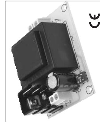
Dieses Gerät ist ein äußerst vielseitiges Festspannungs-Netzteil, dessen IC-Spannungsregler einen internen, elektronischen und thermischen Überlastschutz besitzt.
